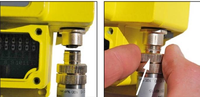
Die Montage des Sensorelements erfolgt über das Stecken der Kontakte und anschließendem Verschrauben des Sensors mit der unteren Rändelschraube im Uhrzeigersinn. Der Sensor sollte handfest angezogen werden. Ein leichtes Spiel zwischen Messumformer und Sensor ist fertigungsbedingt zu akzeptieren.
