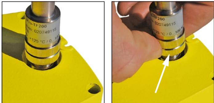
Die Montage des Sensorelements erfolgt über das Stecken der Kontakte und anschließendem Verschrauben des Sensors mit der unteren Rändelschraube im Uhrzeigersinn. Der Sensor sollte handfest angezogen werden. Ein leichtes Spiel zwischen Messumformer und Sensor ist fertigungsbedingt zu akzeptieren.
